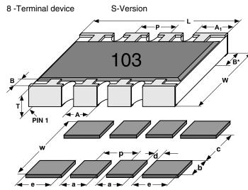
**DIMENSIONS** [in millimeters] PIN MODEL NO# L Α **A**\* В B\* Ρ Т w CRA12E 4 2.54 0.79 0.51 0.38 1.27 0.53 3.05 -CRA12E 5.08 0.79 0.53 8 -0.51 0.38 1.27 3.05 CRA12S 8 5.08 0.79 0.89 0.51 0.38 1.27 0.53 3.05 CRA12E 10 6.40 0.79 -0.51 0.38 1.27 0.53 3.05 CRA12S 10 6.40 0.79 0.89 0.51 0.38 1.27 0.53 3.05 CRA12E 16 10.30 0.79 0.51 0.38 1.27 0.53 3.05 -TOL 0.15 - 0.15 - 0.15 0.25 - 0.2 - 0.1 - 0.1 - 0.15
